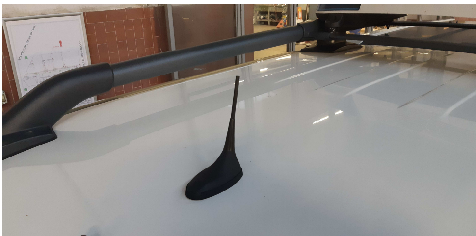
All. 5 – Antenna integrata GPS / UHF ¼ onda (450 – 460 MHz)
